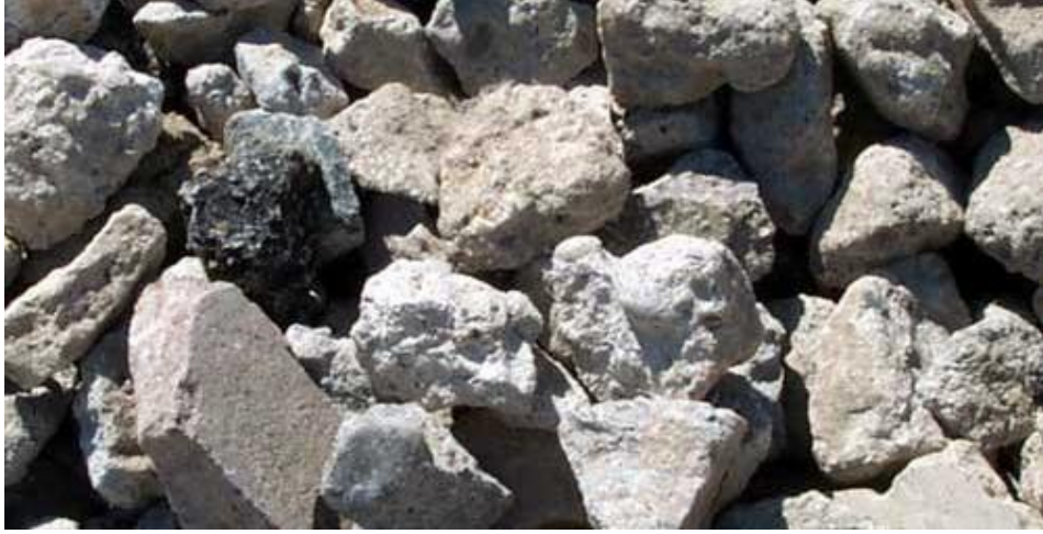
الشكل (2-8): صورة تبيّن شكل كتل الحجارة (الدبش Rubble) بعد التكسير وعزل الحديد والشوائب
