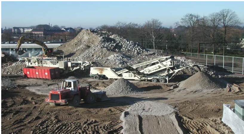
الشكل ( 28-2 ) : مواد البيتون المكسرة كمواد لإنشاء الطرق.
