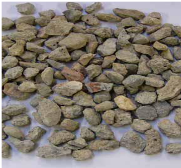
شكل رقم (2-10) يمثّل حصىات مدورة من الدبش بعد طحنه وغربلته.
